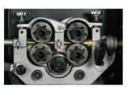
Il sistema di trascinamento a 4 rulli, azionati da ingranaggi è dotato di un motore robusto e di grandi rulli (41 mm) a doppia scanalatura, per un'alimentazione del filo uniforme e precisa, con velocità comprese tra 1 e 20 m/min.
