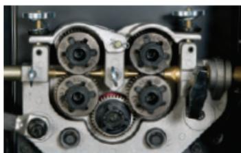
Il sistema di trascinamento a 4 rulli, azionati da ingranaggi è dotato di un motore robusto e di grandi rulli (41 mm) a doppia scanalatura, per un'alimentazione del filo uniforme e precisa, con velocità comprese tra 1 e 20 m/min.
