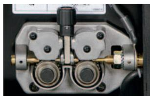
Alimentatore resistente in fusione d'alluminio integra un rullo trainafile a due scanalature a cambio rapido, con tensionatore a molla e manopola di tensionamento calibrata, progettata per facilitare e velocizzare la configurazione.
