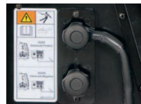
Il facile accesso ai morsetti di uscita consente di cambiare polarità in modo pratico quando si passa alla saldatura con fili animati o con fili pieni.
