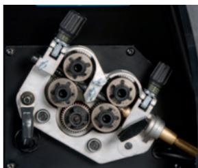
Il sistema di trascinamento a 4 ingranaggi è dotato di rulli trainafilo reversibili a sostituzione rapida senza utensili (1,0/1,2 mm). Esso è dotato inoltre di una manopola di regolazione della tensione di facile utilizzo.
